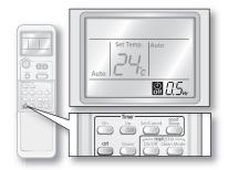
Установите желаемое время автоматического выключения кондиционера.
